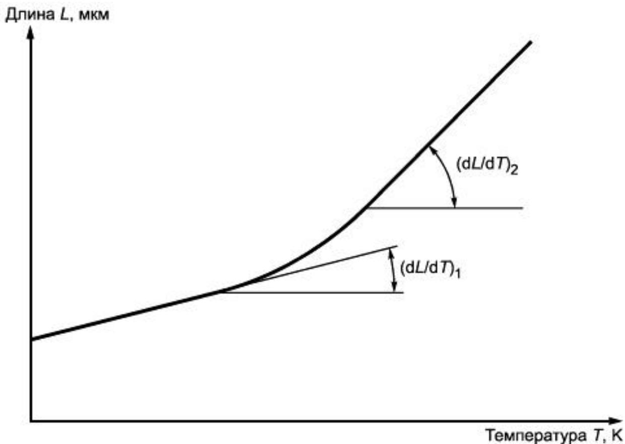
Рисунок 7.1 - Определение коэффициента линейного теплового расширения
