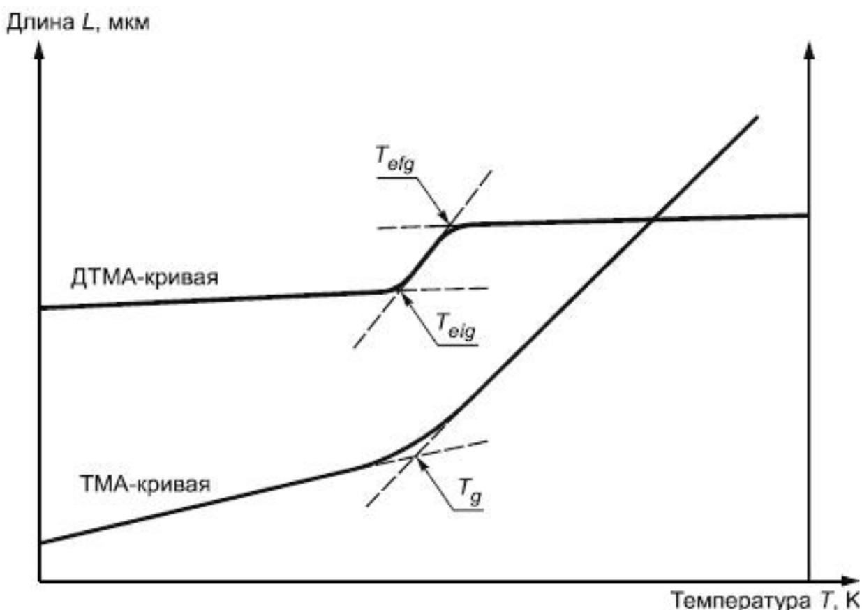
Рисунок 7.3 - Определение температуры стеклования
