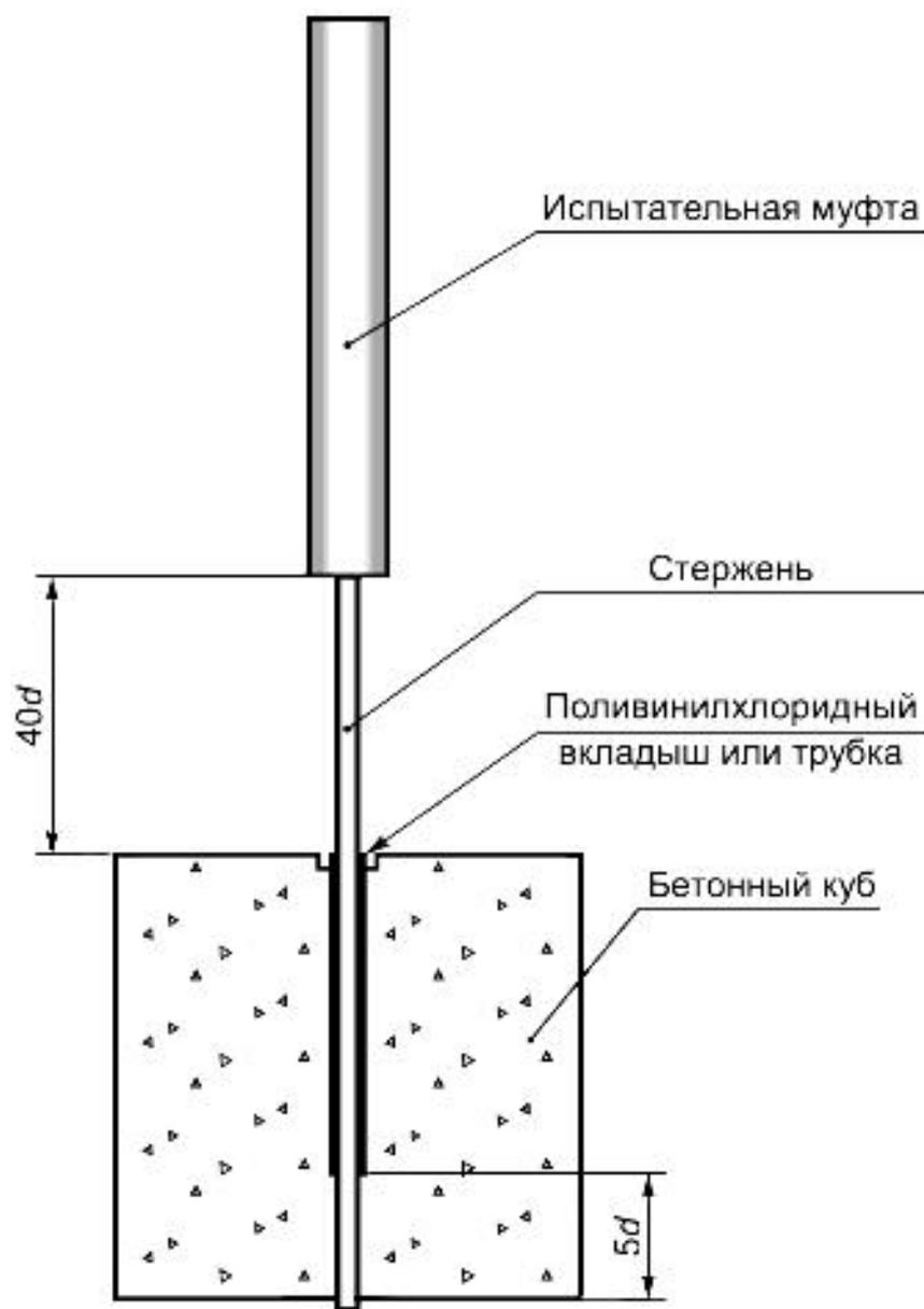
Рисунок 6.1 - Схема установки АКП в бетон куба
