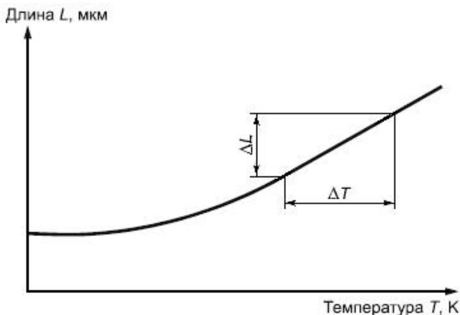
Рисунок 7.2 - Определение среднего коэффициента линейного теплового расширения  $\bar{\alpha}$
